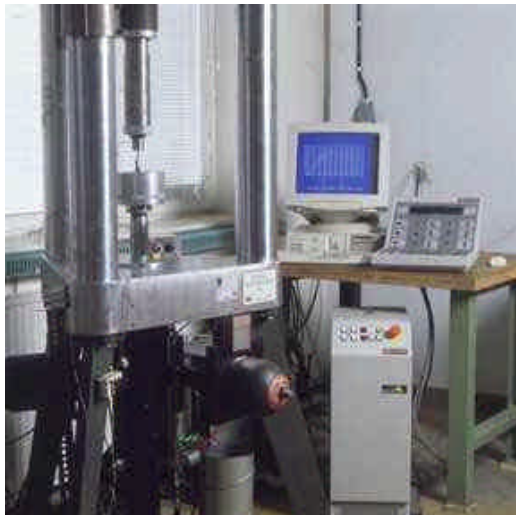
Figur 3. Servohydralisk dragprovsmaskin MTS 30kN med styrenhet Instron plus 800.
