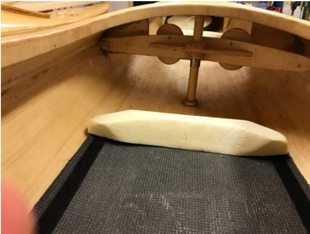
Pedalstellet sett forfra. Den dreibare horisontallista er laminert og bueforma.
