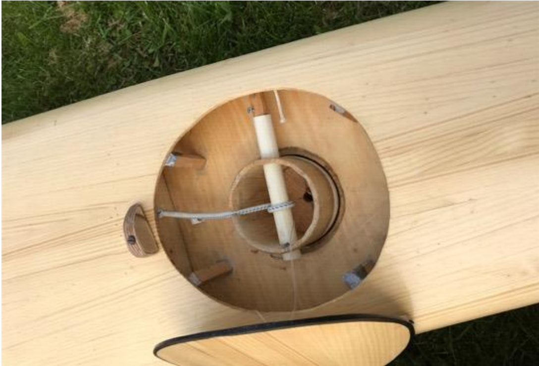
Under rorluka: En indre dreiesylinder med rorkult, nedtrekksstropp og liner.
