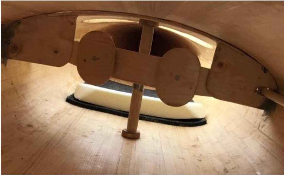
Pedalstellet sett bakfra. K-rør med rundstav på høyre side.
