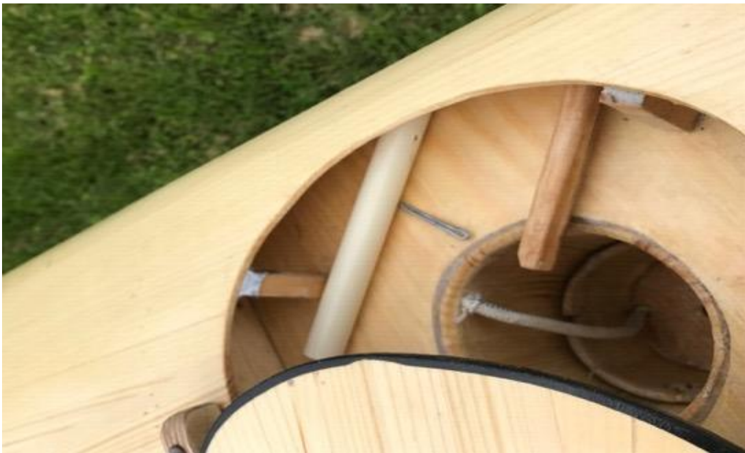
Rorkulten er demontert og dreiesylinderen er på vei ned. Staven fra pedalene ligger gjemt langs relinga.
